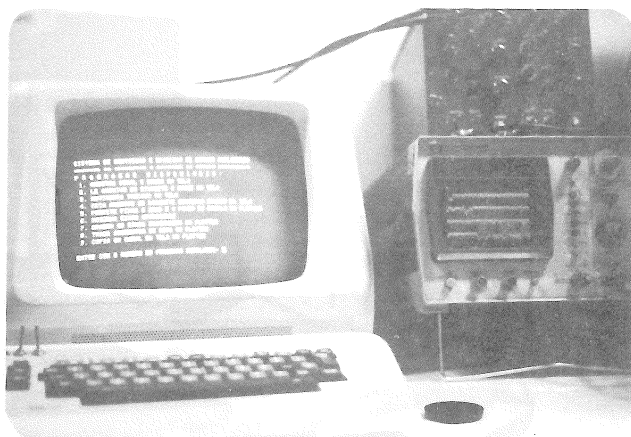
FIG. 5 - Osciloscópio mostrando conteúdo de um arquivo
